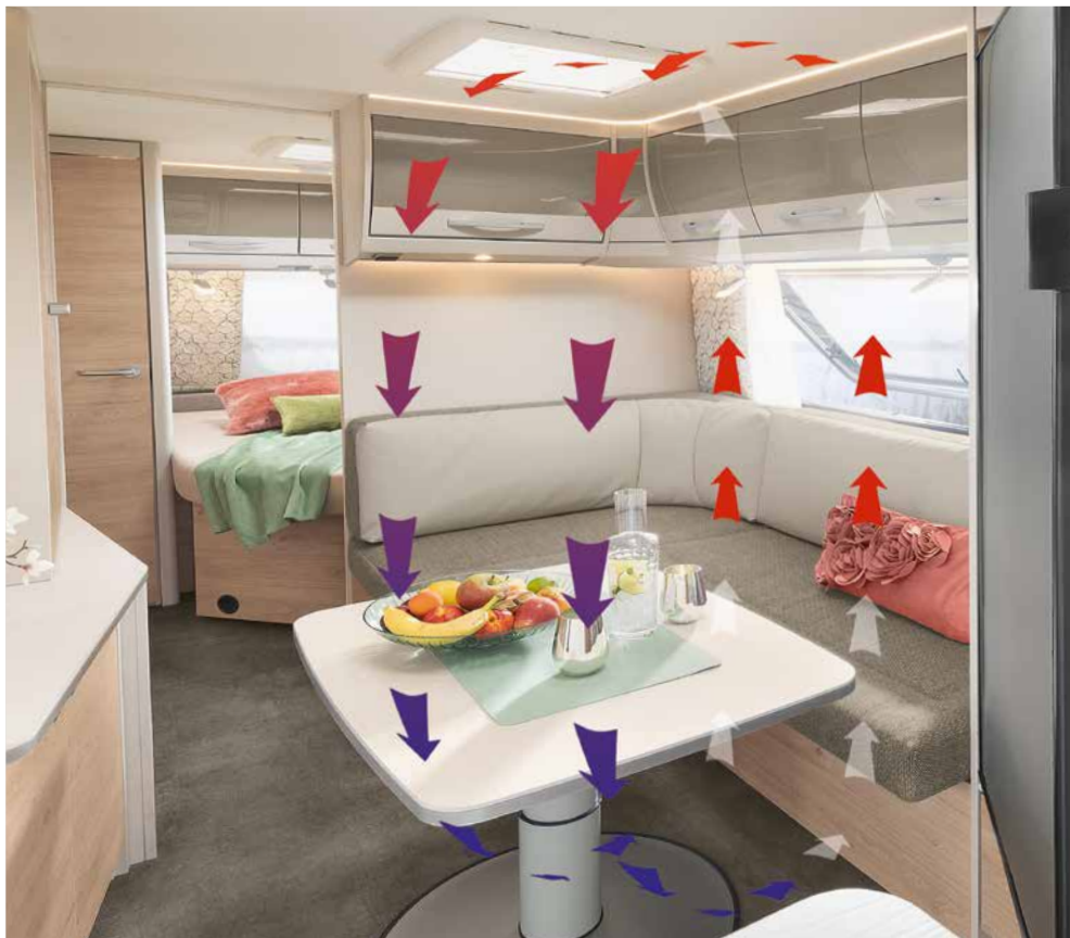
AirPlus-systemet sørger for utlufting bak overskapene og forhindrer at det dannes kondensvann
